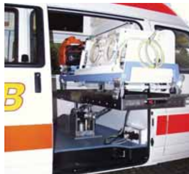
Kein gefährliches Geruckel mehr, durch adaptiv gedämpfte Technik im Krankenwagen sinkt das Risiko auf der Fahrt ins Krankenhaus.
